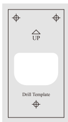
Szablon otworów dla panelu domofonu (1 szt.)
