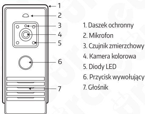
Rys. 2. Budowa kasety zewnętrznej
