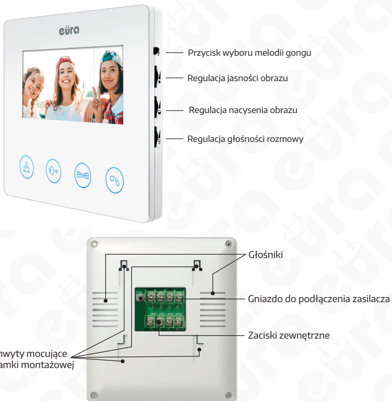
Rys. 1. Budowa monitora VDA-52A3
